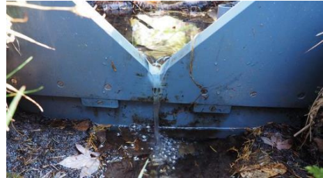
Figure 34 : Vue en plan des seuils jaugés installés au Luitel
