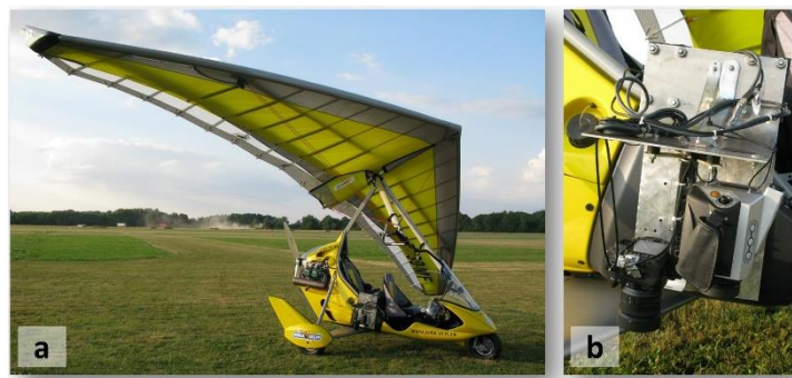
Figure 1 (a) Exemple de vecteur (ULM) et (b) zoom sur les capteurs (appareil photo et caméra thermique). Source : Jura ULM, Baptiste Marteau
