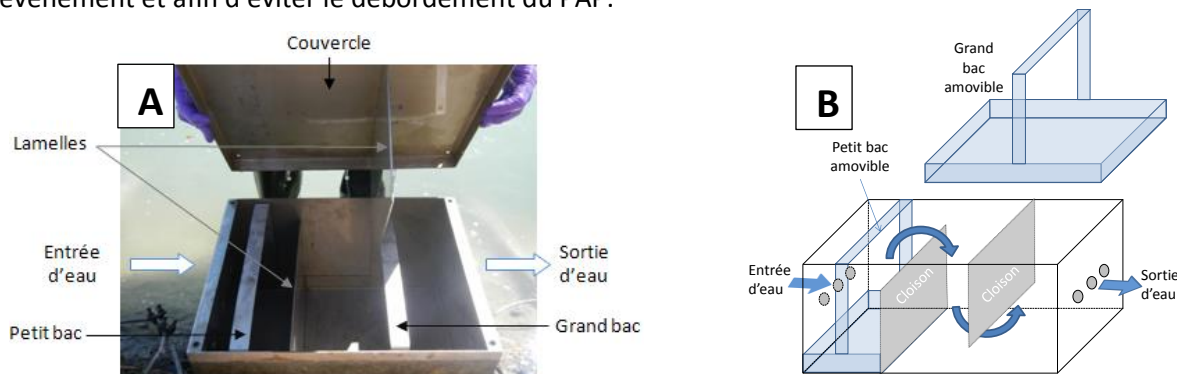
Figure 1 : Présentation du piège à particules : (A) photo d'un piège à particules ; (B) schéma de fonctionnement
