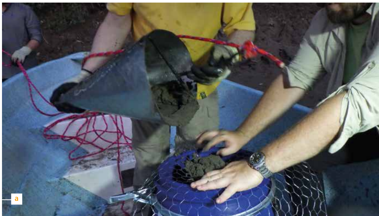
Figure 4.2 : Prélèvements manuels des sédiments de l'Usumacinta : (a) avec cône, (b) avec pelle, (c) avec seau. © I. Djeran-Maigre, avril 2018.
