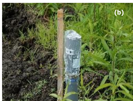
Figure 9. a. Drain à proximité des exclos. b. piézomètre installé au milieu chaque exclos entre la partie décapée et non décapée.
