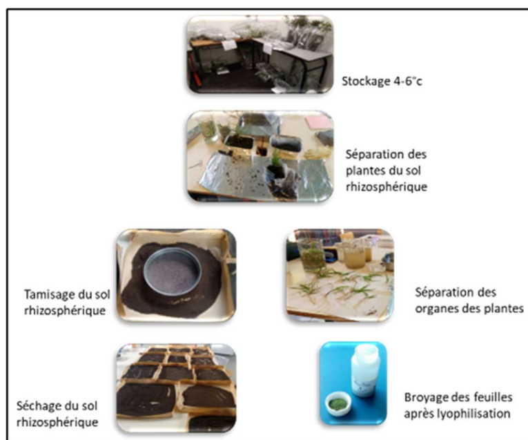
Figure 1 - Illustration de quelques étapes-clés de la méthodologie de préparation des échantillons de plantes et de sols rhizosphériques avant analyses
