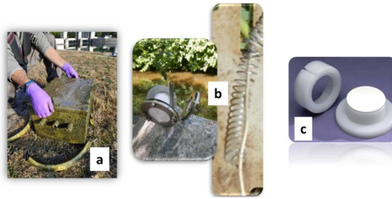
Figure 5 : Dispositifs proposés pour l'échantillonnage intégratif des contaminants dans la phase particulaire (a : piège à particules) et dans la phase dissoute (b : POCIS/tiges silicones ; c : DGT).
