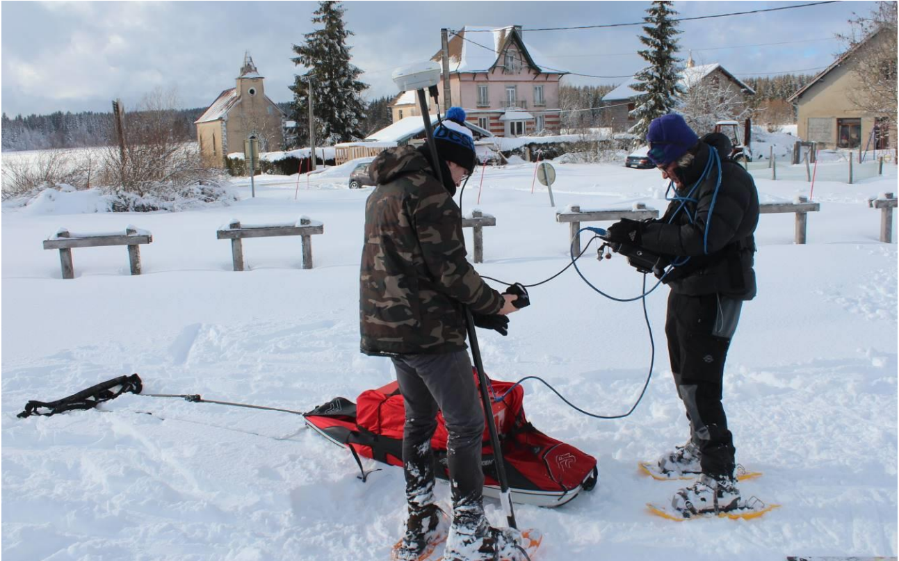
Figure 51 : Adaptation de l'antenne 200 Mhz sur une pulka pour les campagnes hivernales.
