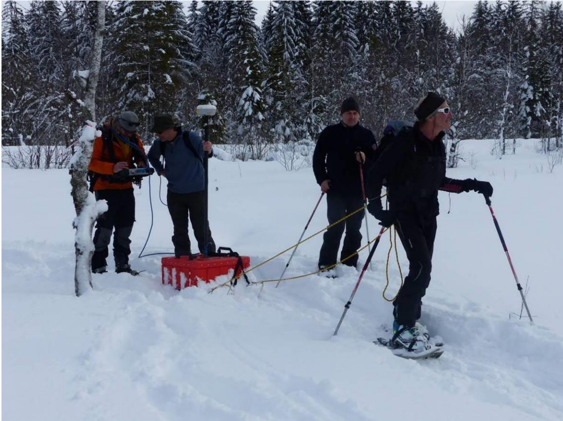
Figure 46 : Acquisition GPR en hiver sur la tourbière de Frasne (25) – Février 2022
