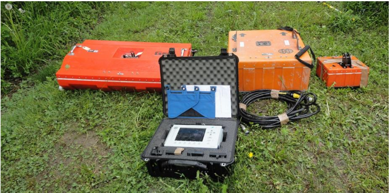
Figure 50 : Le système d'acquisition SIR-3000 au premier plan, et de gauche à droite les antennes de 100 (non utilisée dans cette étude), 200 et 400 Mhz
