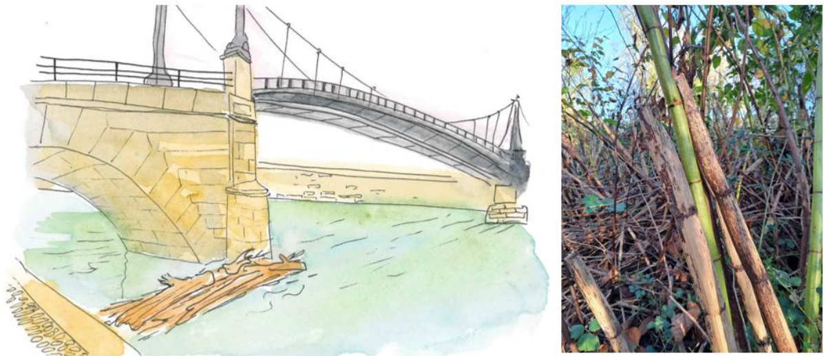
Figure 10. Formation d'un embâcle au pied d'un pont (à gauche) par accumulation de cannes sèches de renouées en hiver (à droite)
